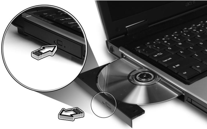
若在電腦電源關閉時，您可將拉直的迴紋針插入緊急退出孔來退出光碟機托盤。
