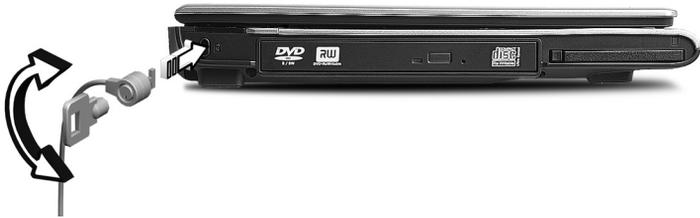
將電腦安全鎖電纜線繞著無法移動的物品打個圈，例如，桌子或鎖住的抽屜把手。再將鎖插入插槽中，並轉動鑰匙以便上鎖。另外一些沒有鑰匙鎖孔的機型，也可提供使用者來選擇。
